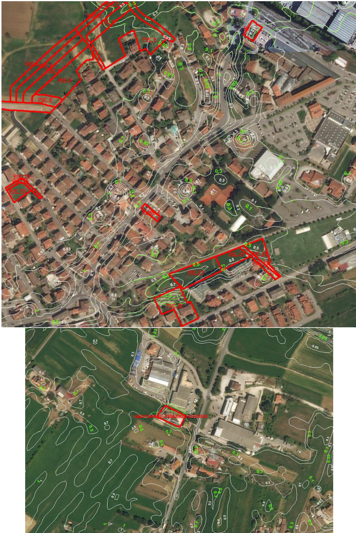
Figura 8-2: Verifica del non incremento di rischio nelle aree contermini mediante il confronto dei battenti forniti da FLO-2D nelle configurazioni attuale (contours verdi) e di progetto (contours bianchi).
