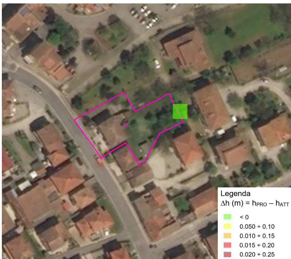
Figura 8-6: Perimetro del comparto ASr 01 e indicazione delle celle di calcolo in cui si è calcolato un incremento di battente idraulico nello scenario di progetto rispetto allo scenario di stato attuale.
